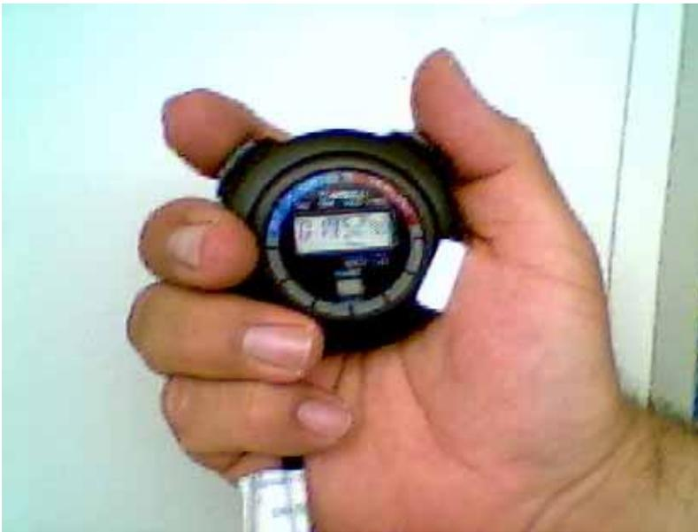
1. Reducir el error sistemático en la toma de lectura ocasionado por el accionamiento manual de los botones de arranque y paro del cronómetro.
